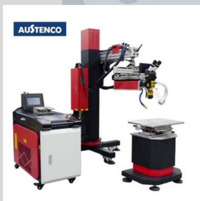
COM-RL-B1500 دستگاه جوش لیزر فیبری جهت تعمیرات قالبهای بزرگ صنعتی
